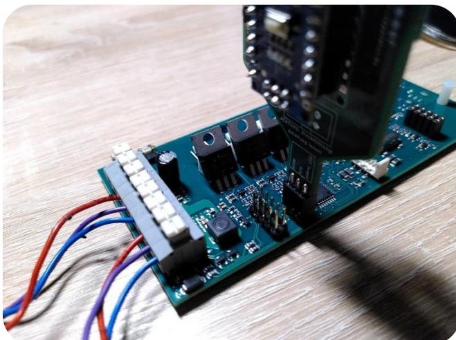
Entnehmen Sie den Programmier-Adapter und das USB-Kabel für die Spannungsversorgung dem Kit. Der Programmier-Adapter muss, wie im Bild gezeigt, auf dem 6-poligen Pin-Header aufgesteckt werden. Wichtig ist hierbei, dass der blaue uC (Arduino Nano) in Richtung der Klemmleisten zeigt.
